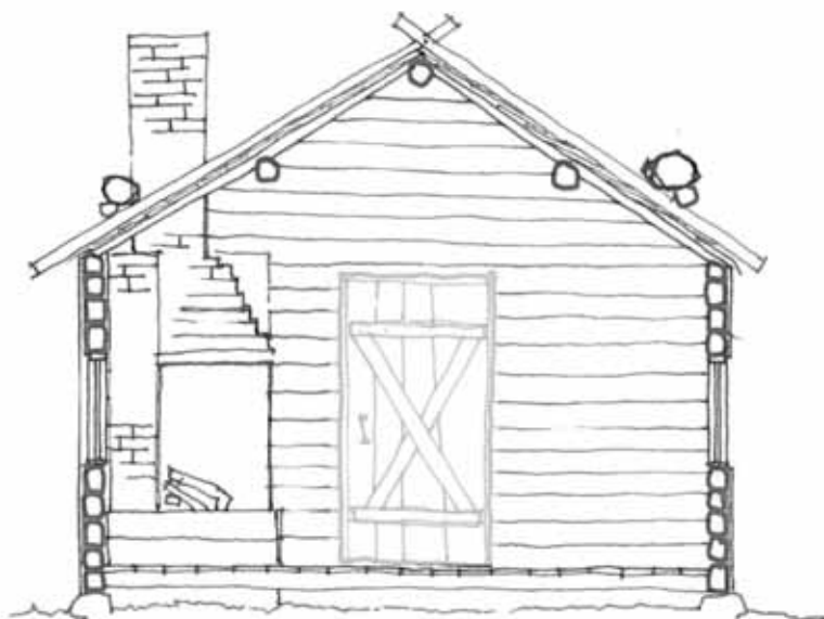
Ursprunglig fiskarbastu, skärning Alkuperäinen kalastajakämpä, leikkaus
